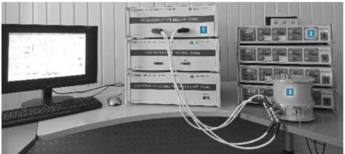
Рис. 3. Вимірювальна система провайдера для вимірювання електричної ємності (1 – компаратор 5100; 2 – еталонна міра; 3 – міра P 597)
