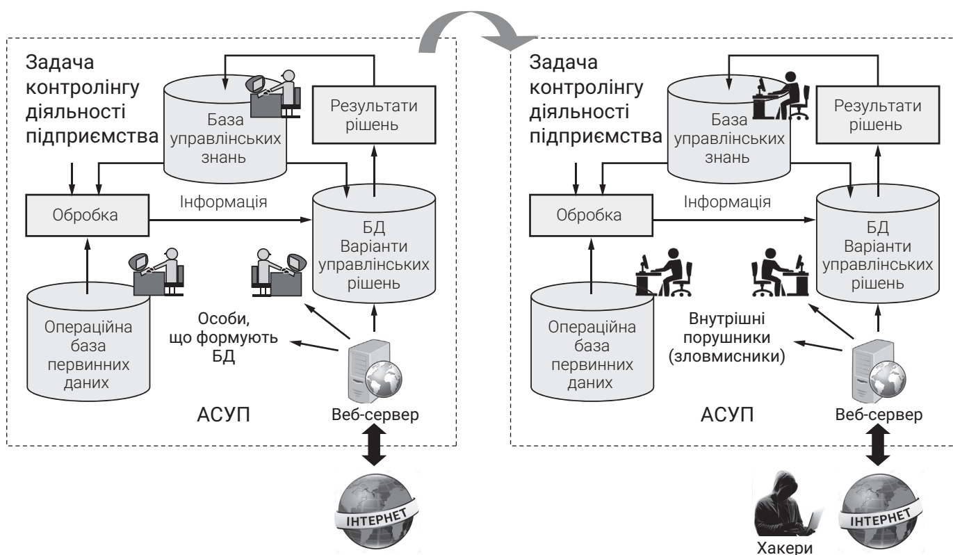
Рис. 3. Структурна модель можливих інцидентів внутрішніх та хакерських спотворень баз даних підприємства (авторська модель)
