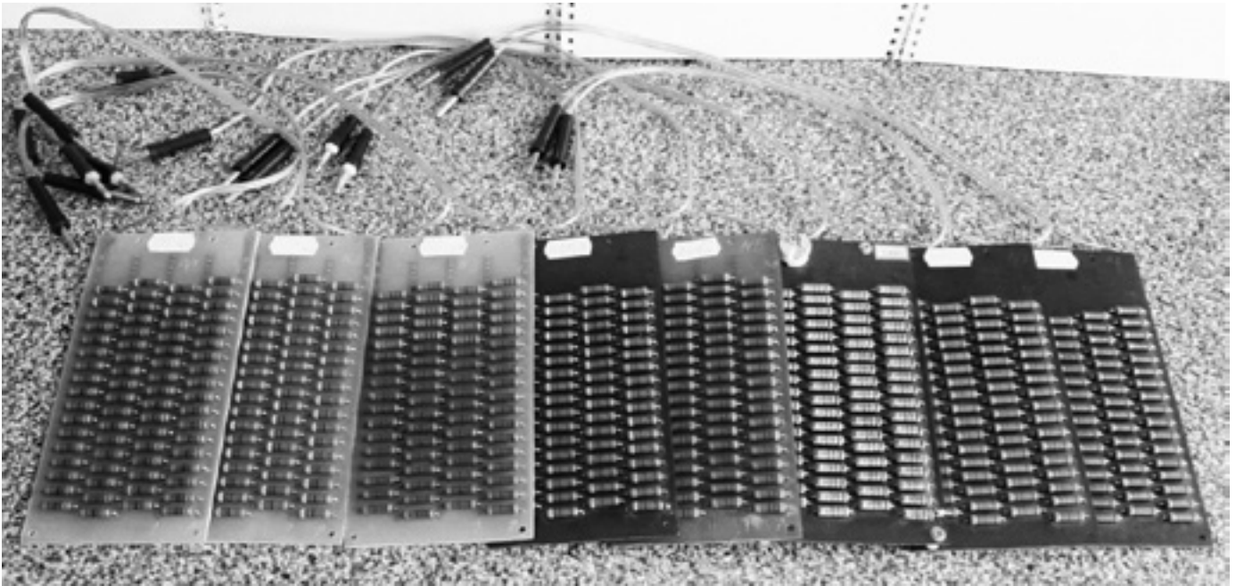
Рис. 2. Навантажувальні опори для випробування ВЧ апаратів серії EXBЧ «Надія-4» на основі лінійок резисторів типу MOR300S
